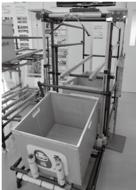
写真4 空箱投入を自動化した「だるま落とし」
