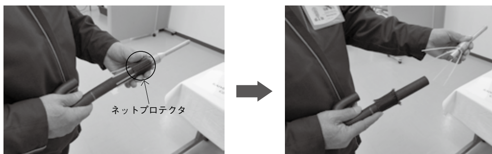
写真3 仕入先のパート社員のアイデアから生まれた、ネットプロテクタ挿入治具
