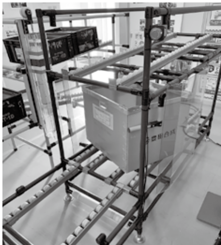
写真6 「箱コプター」をさらに無動力で回転できるようにした「回れ右」
