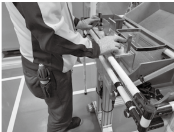
写真2 2本のボルトをワンプッシュで締め付け
