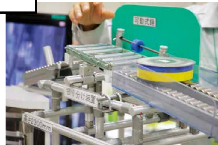
トヨタ自動車東日本株式会社 『ポンプからくり自動搬入装置』
